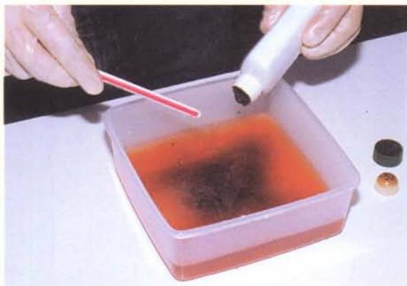
Figura 5.28. Preparación del percloruro férrico
